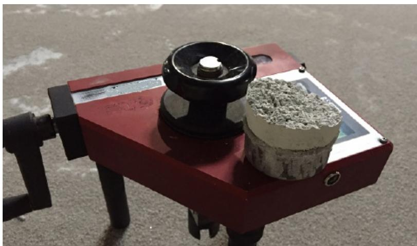
Si deve verificare che dopo lo strappo del dolly la rottura sia sempre di tipo *coesivo* (*distacco del rivestimento con parte del sottofondo*) e che tale presenza di parte della superficie di posa (a), aderente alla superficie del dolly, sia maggiore del 50% della superficie del dolly (A):  $a \geq 0,5 A$ .
