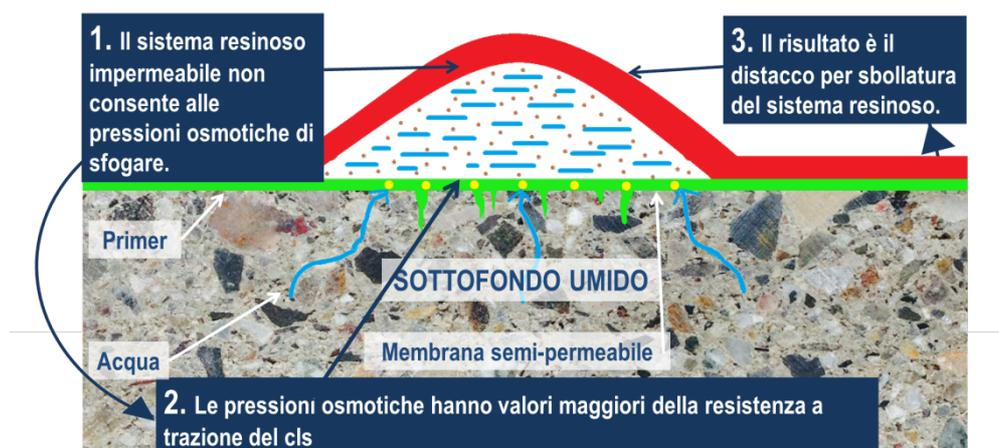
Il fenomeno della “sbollatura” dei rivestimenti resinosi si verifica sui sistemi fino a 2-3 mm massimi di spessore, o anche più nel caso dei sistemi elastici. Può presentarsi con qualche sporadica bolla sparsa sulla superficie o molto più intensamente e diffusamente interessando complete aree di pavimentazione fino a compromettere seriamente la funzionalità del rivestimento.
